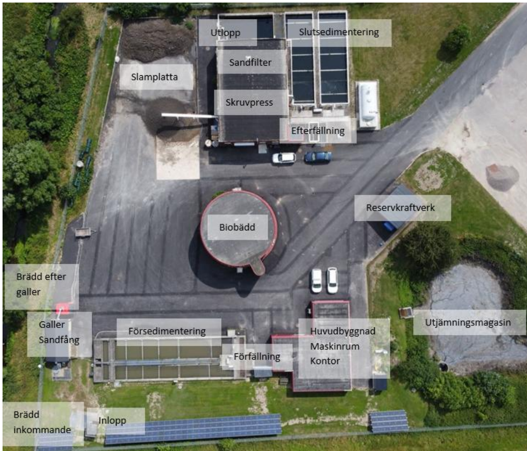
Figur 5. Foto över Svalöv reningsverk som presenterar de olika reningsstegen.
