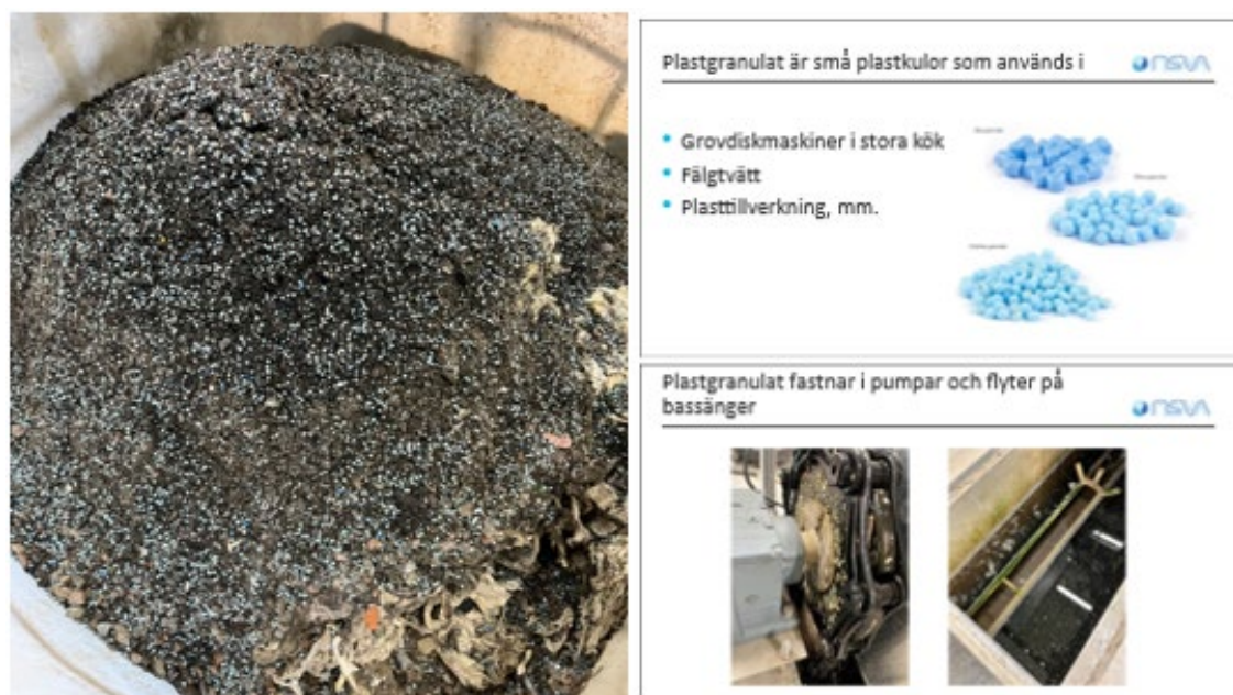
Figur 14. Plastgranulat kommer till reningsverket via inkommande spillvatten.
