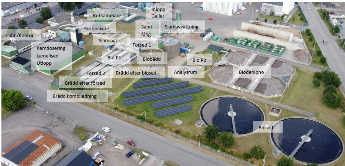
Figur 5. Foto över Lundåkraverket som presenterar de olika reningsstegen.
