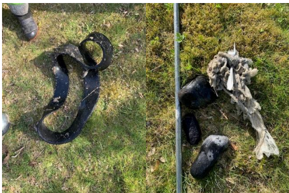
Bilder: Tättningsring, stora stenar och traspaket orsakade stopp i ledning.
