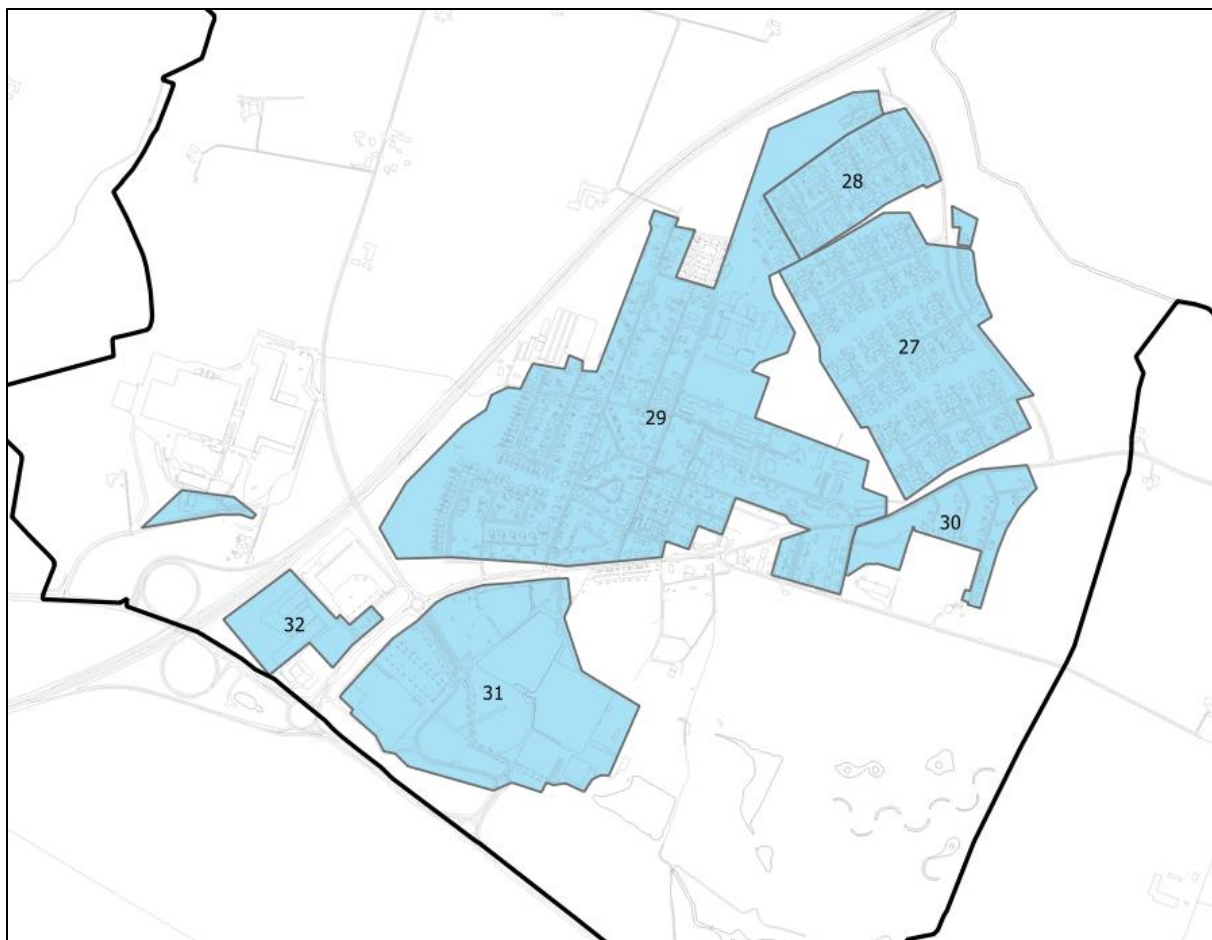
Figur 6 – Definierade avrinningsområde med ett dagvattenutlopp i Hyllinge.
