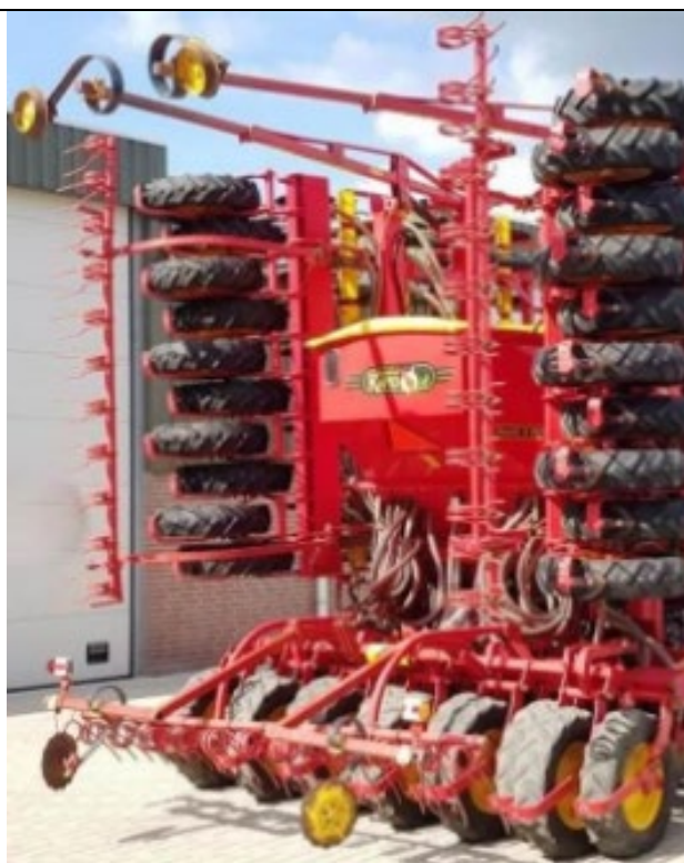
En Väderstad Rapid såmaskin används på Bangsbo. Bredd 8 meter.
