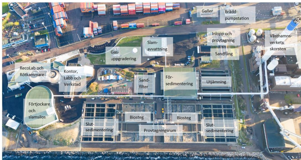
Figur 4. Foto över Öresundsverket och dess olika reningssteg.
