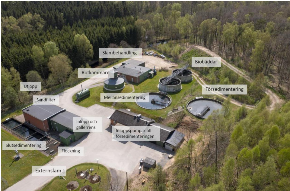
Figur 3. Foto över Örskelljunga ARV och de olika reningsstegen.
